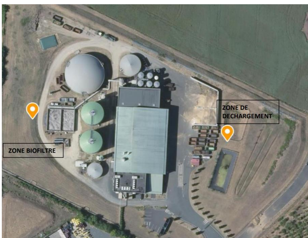
Figure 52 : Points de mesures des émissions odorantes sur le site principal (Rapport APAVE 11/09/2025)
