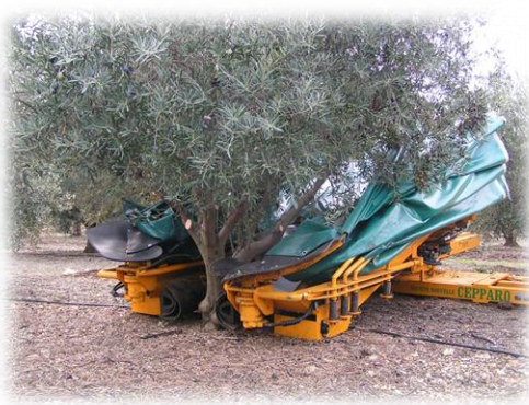
Figure 19 – Corolle associée à un vibreur pour la récolte d’olive
