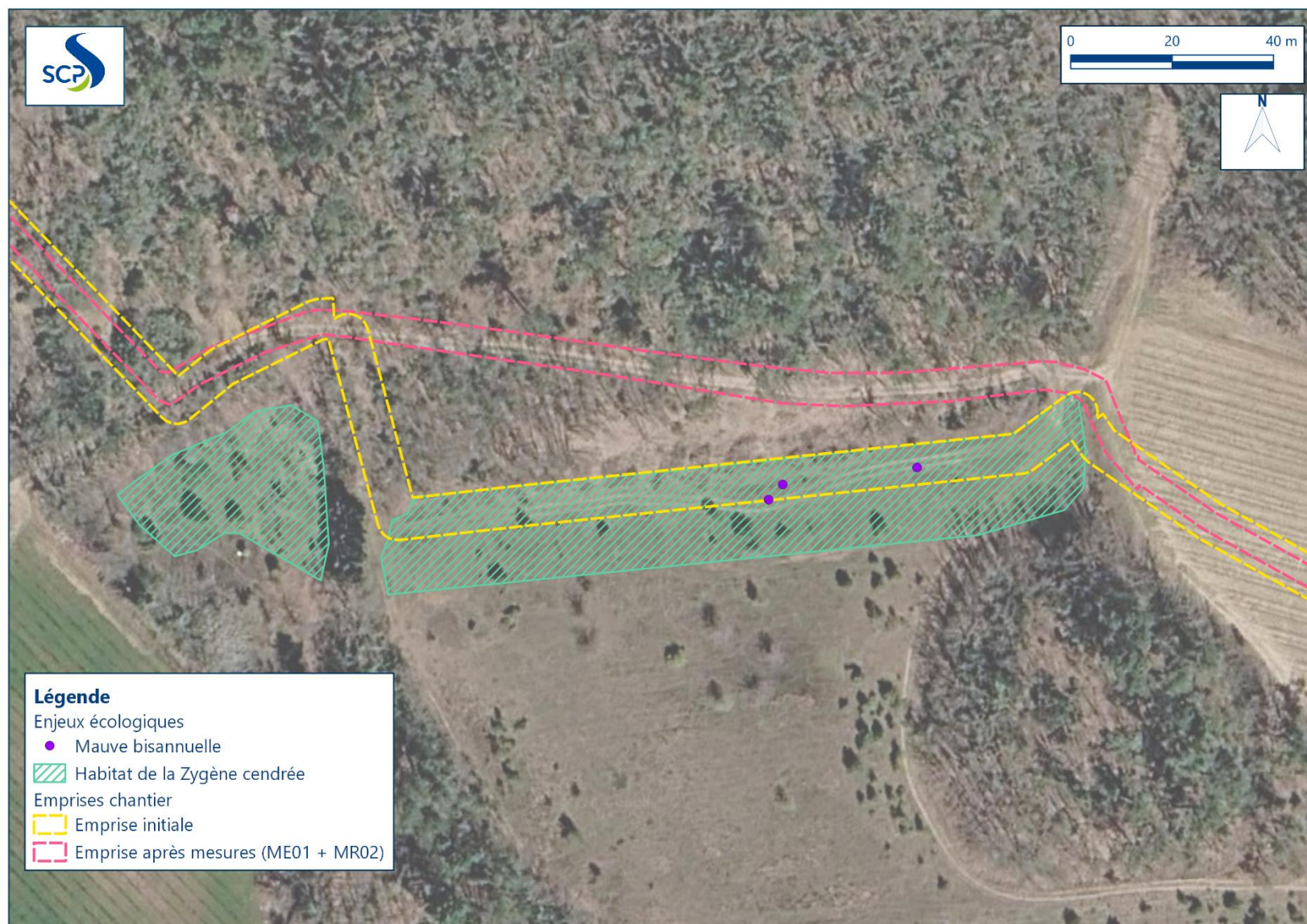
Carte 12 : Passage sous chemin forestier pour éviter une station de Mauve bisannuelle et un habitat à Zygène cendrée (ME01) et réduction de l'emprise chantier à la largeur du chemin pour réduire l'abattage d'arbres (MR02)
