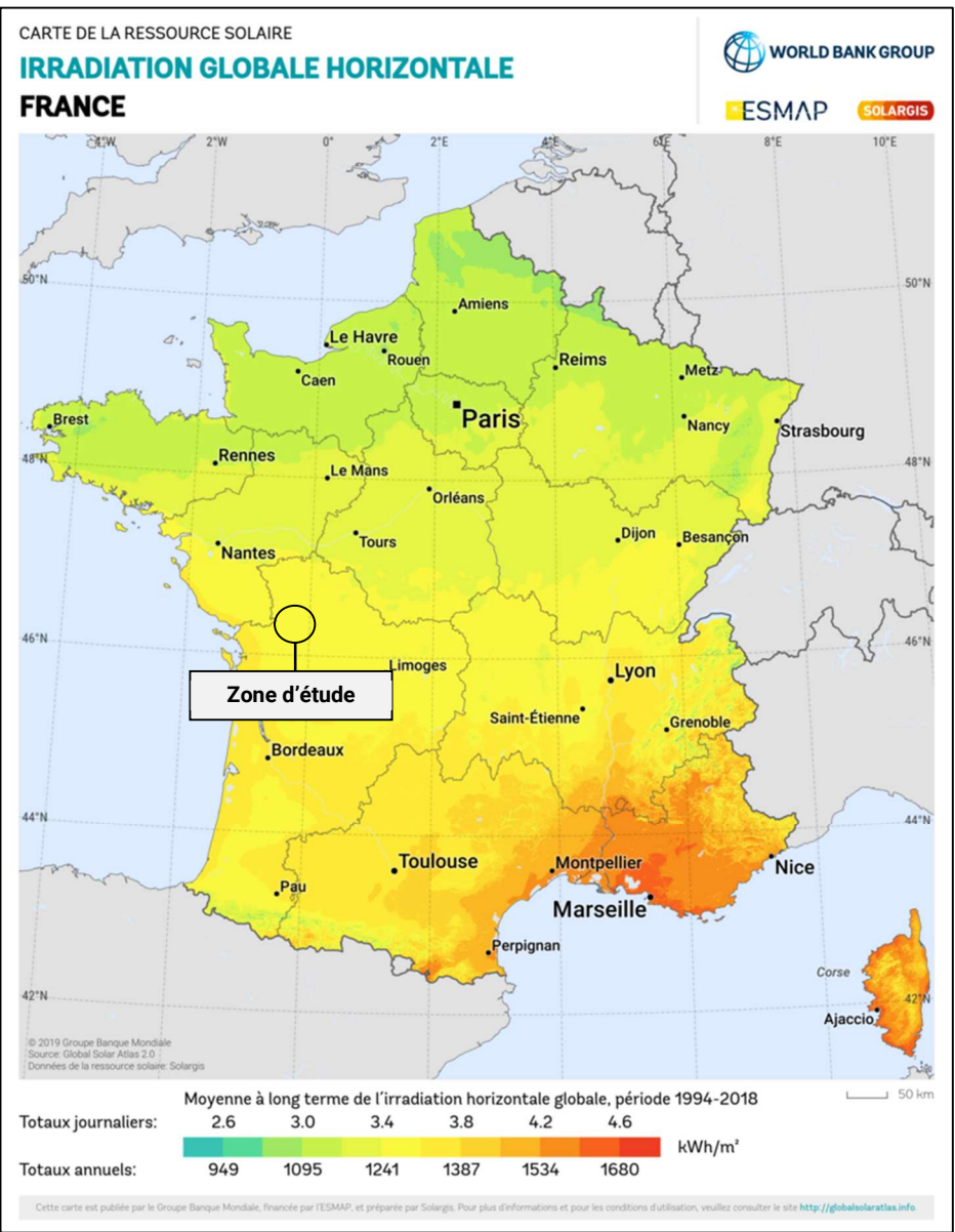
Figure 6 : Irradiation globale annuelle de la France reçue par les modules photovoltaïques (en KWh par an et par m²).
