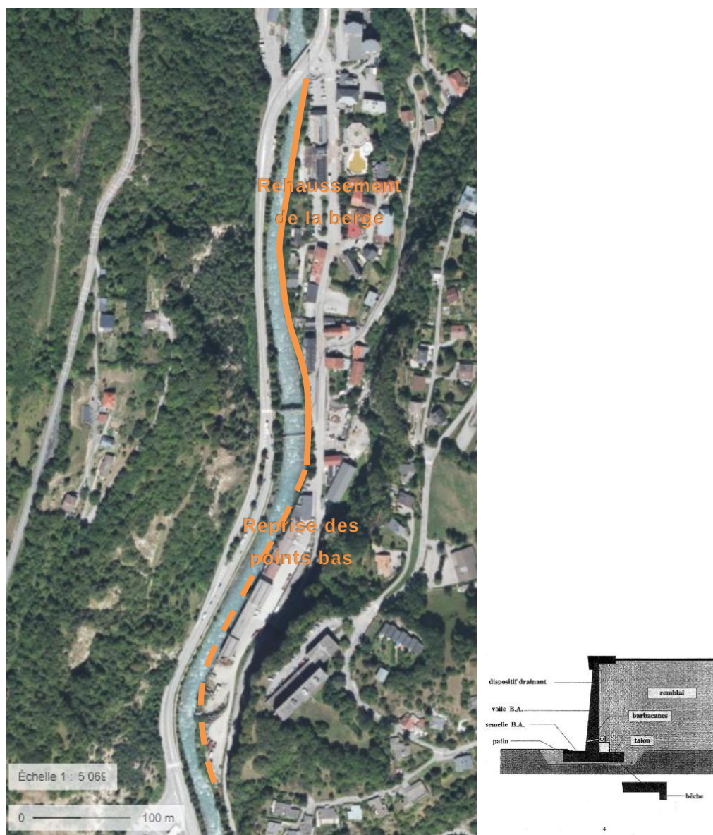
Figure 48 : Confortement berge par murets/parapets RD Salins les Thermes - LOMBARDI
