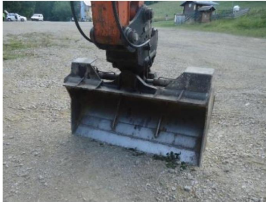
Figure 35 : Godet à utiliser pour l'étrépage -©Karum
