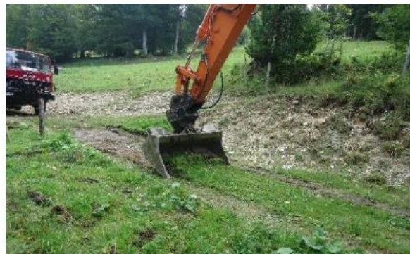
Figure 36 : illustration de la méthode d'étrépage de la végétation à mettre en œuvre -©Karum
