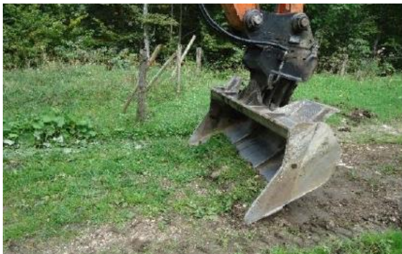
Figure 36 : illustration de la méthode d'étrépage de la végétation à mettre en œuvre -©Karum
