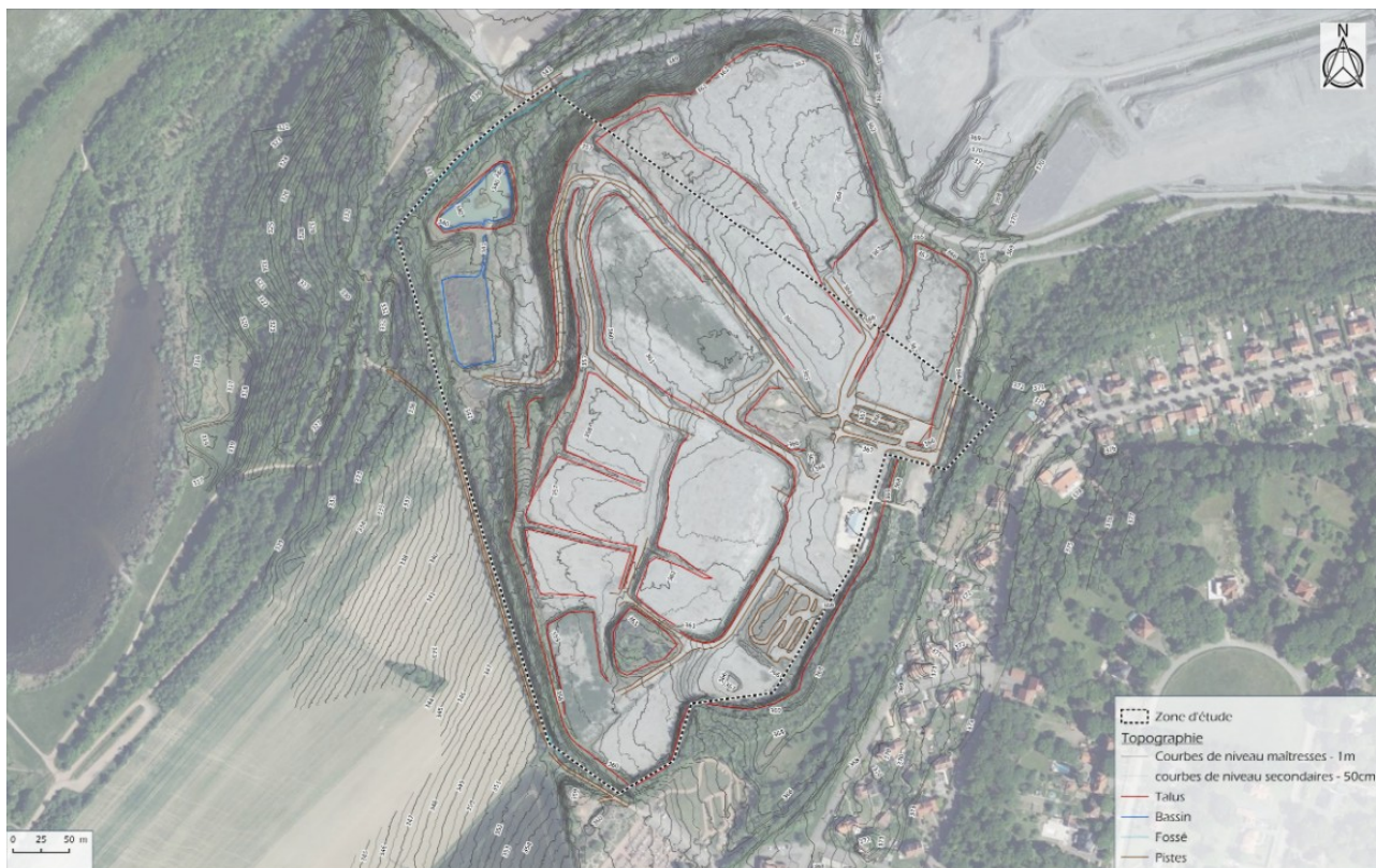
Figure 2: La ZIP présente une topographie en marches d'escalier et est constitué d'un damier de plateformes d'anciens stériles miniers
