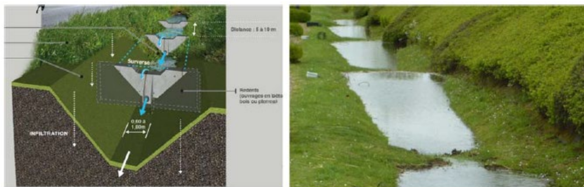
Figure 1 : Principe de fonctionnement d'une noue à redans avec surverse et infiltration
