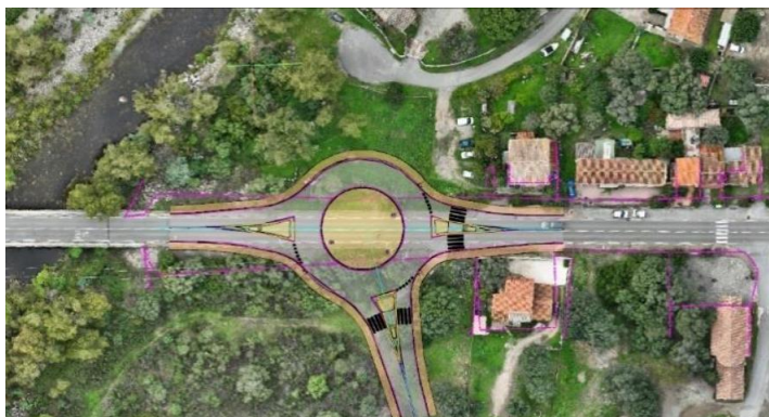
Solution 1 : Aménagement d'entrée d'agglomération de type giratoire
