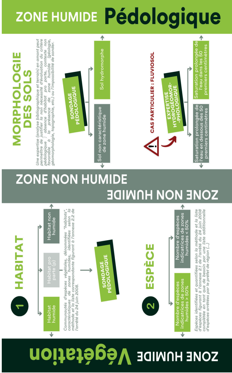
Illustration 1 : Schéma synoptique d’identification des zones humides Source : Artilex 2022
