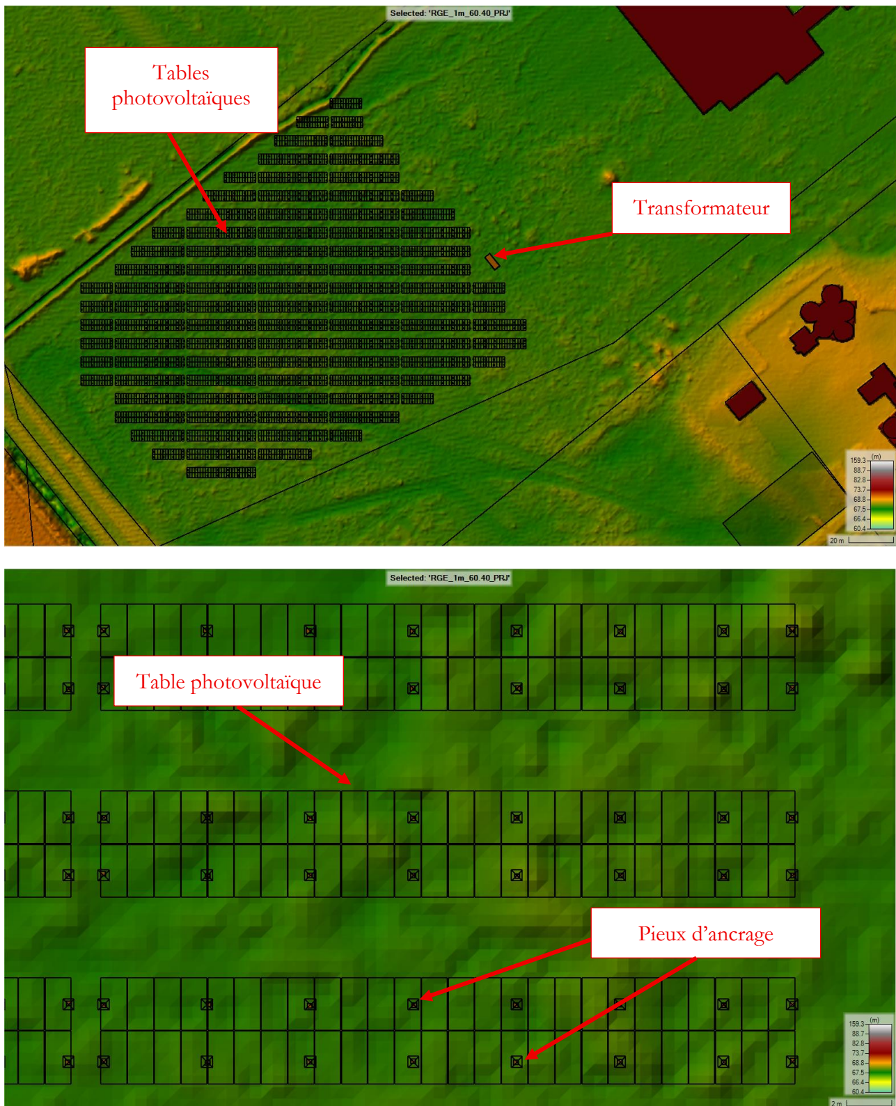
Figure 12 : Modifications du modèle numérique de terrain associées au projet
