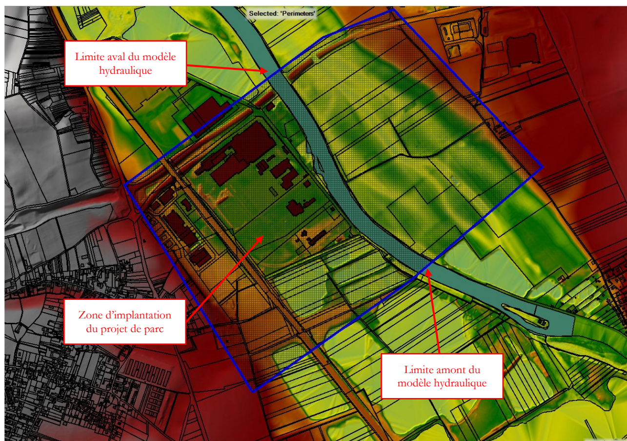
Figure 5 : Emprise du modèle hydraulique
