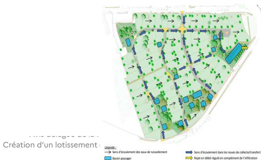
Fig 5 : schéma de principe de gestion des eaux pluviales (EI p. 194)
