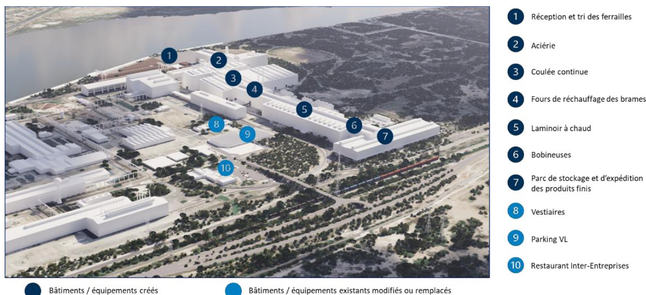
Figure 3 : Description du projet - source : étude d'impact
