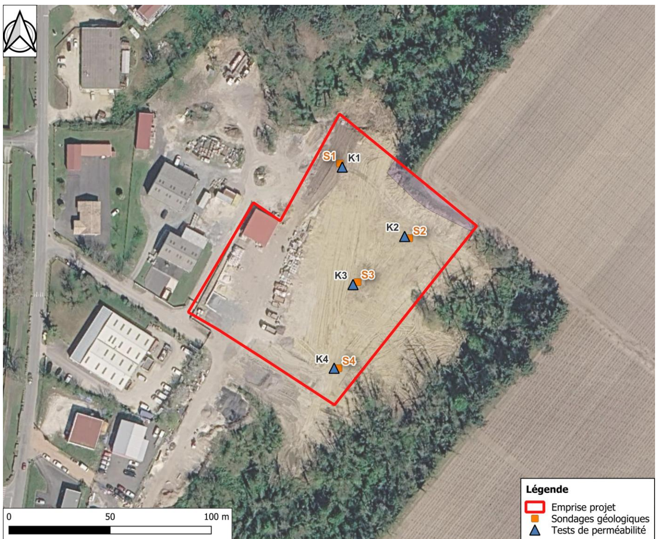
Figure 16 : Localisation des investigations du 30 juillet 2026 (Réalisation : GESOLIA)
