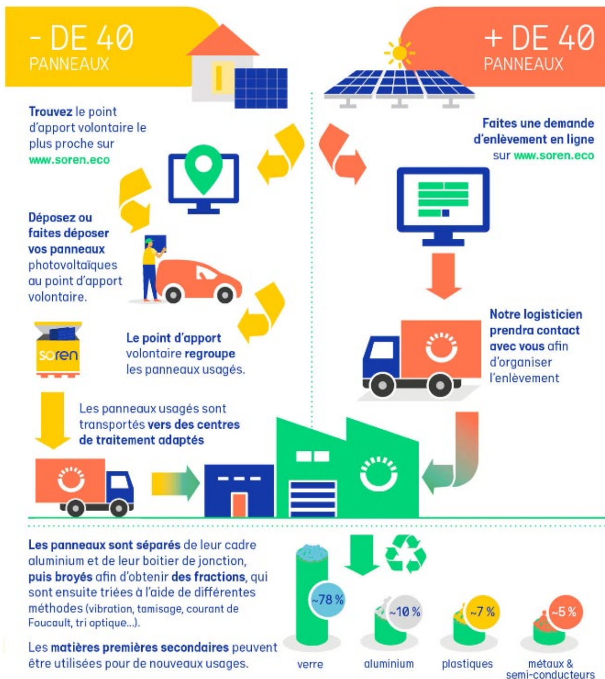
Figure 13 : Schéma de principe du recyclage des panneaux solaire – Source : SOREN
