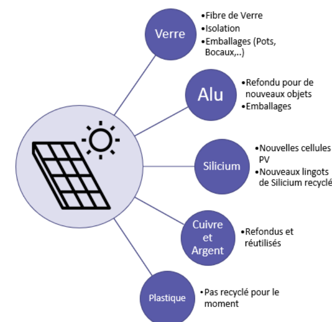
Figure 30: Composants d'un module PV
