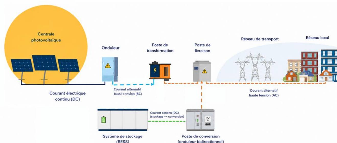
Figure 8 : Schéma de la chaîne de production d'électricité
