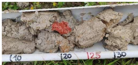
Figure 7 : Réaction positive au test de colorimétrie : Horizon réductique
