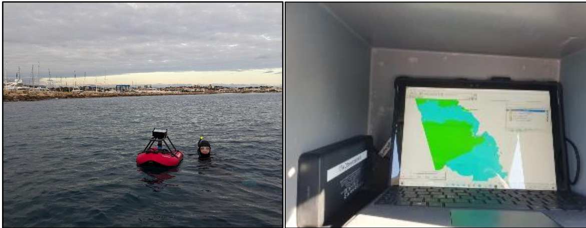
Figure 4 – Système de géoréférencement : DGPS flottant avec fil à plomb positionné par le plongeur + tablette équipée du logiciel de cartographie © P2A Développement
