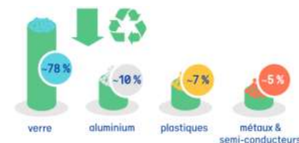
Figure 14 : Composition d'un module photovoltaïque monocristallin
