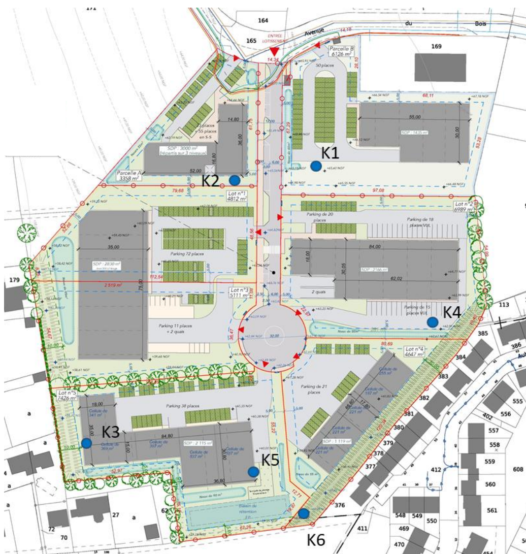
Plan de localisation des tests d'infiltration
