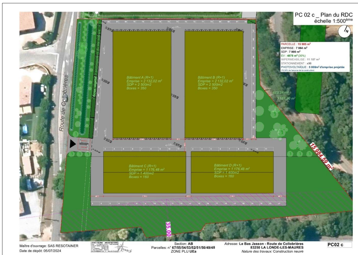
Figure 2 : Plan de masse du bâtiment de self-stockage
