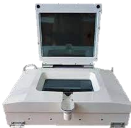
Figure 90 : Appareil ZooScan (HYDROPTIC Inc.) pour la mesure et la classification d'organismes < 5 cm.
