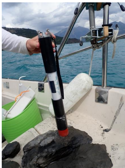
Figure 76 : Sonde Benthos Torch (BBE Moldaenke) en cours de mesure du phytobenthos sur une pierre.
