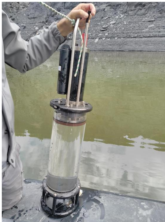
Figure 7 : Echantillonneur d'eau intégrateur IWS III après un prélèvement.
