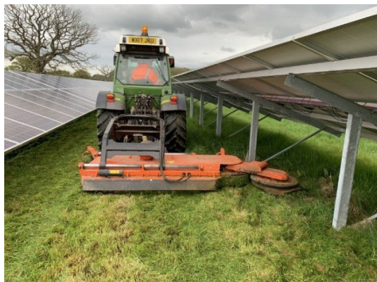
Entretien mécanique des refus avec faucheuse déportée
