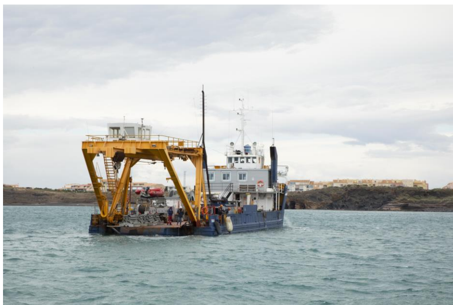
FIGURE 47 : MISE A L'EAU DE RECIF DEPUIS UNE BARGE LOURDE AU CAP D'AGDE POUR LE DEPLOIEMENT DE 32 LESTS DE BALISAGE ECOCONCUS PAR CROCHET AUTOLARGABLE(© SEABOOST, 2019)
