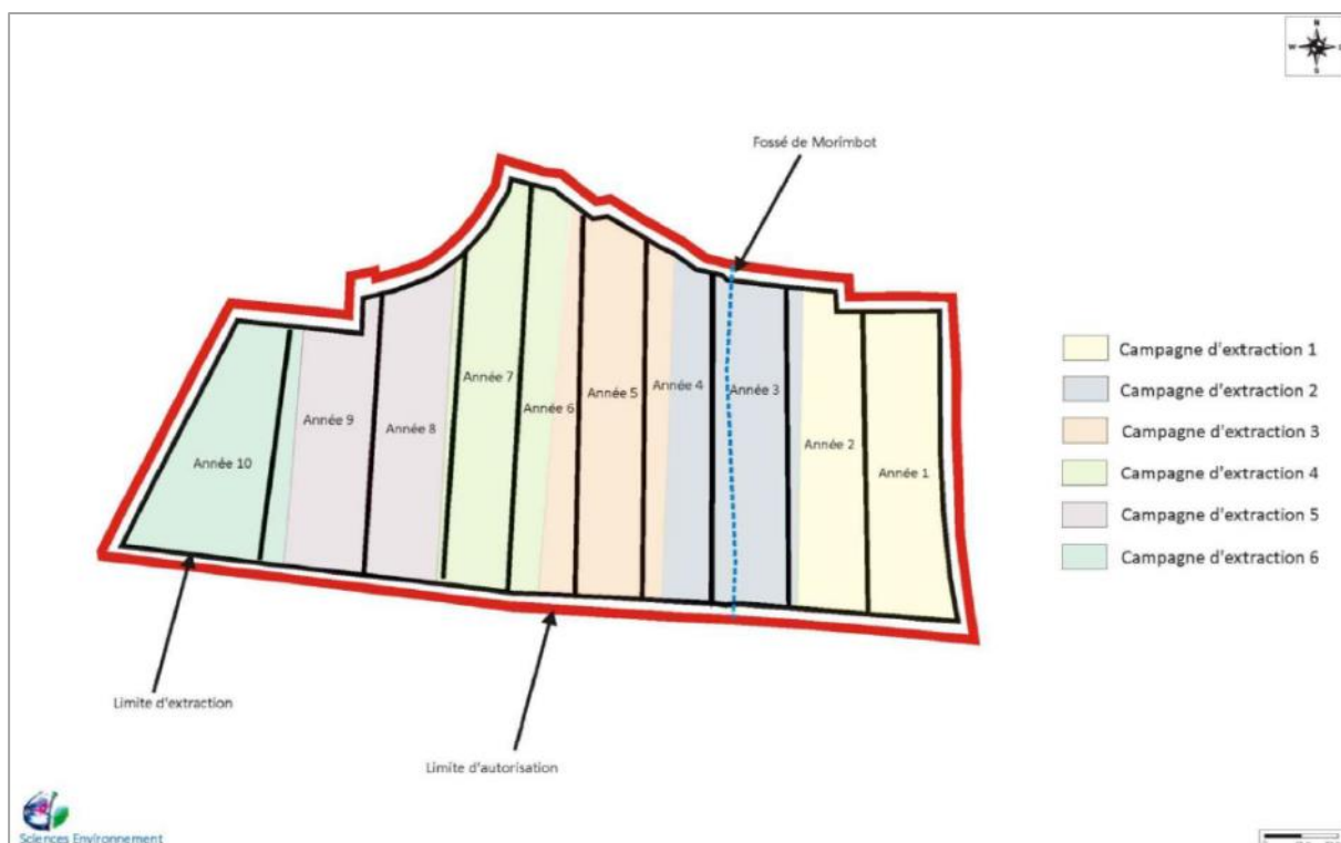
Figure 9 : Phasage de l'extraction et de l'apport de matériaux inertes pour le réaménagement (Source : Sciences Environnement, DDAE de 2015)
