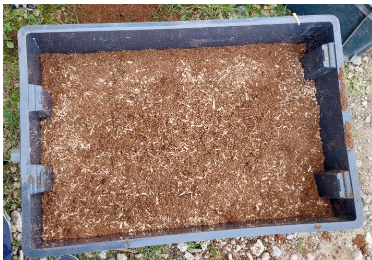
Figure 37 : Photographie du mélange tourbe et miscanthus broyé (couche de 30 cm)
