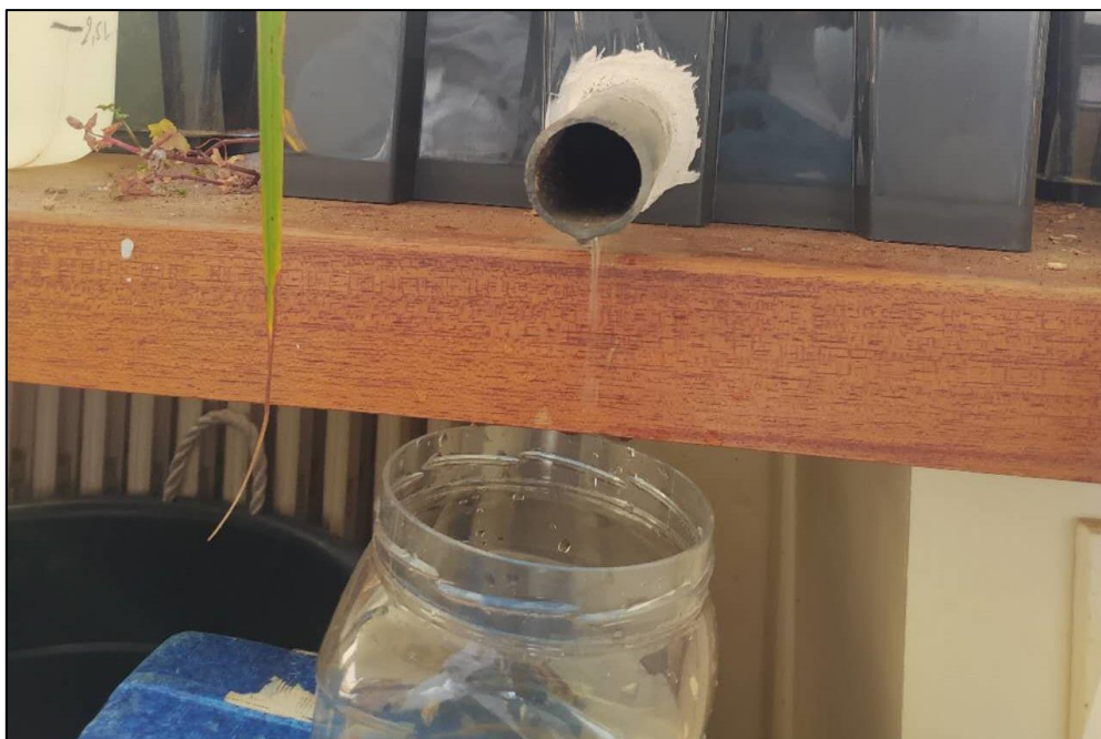
Figure 84 : Photographie de l'expérience en cours : écoulement du lixiviat en sortie de Jardin Filtrant®
