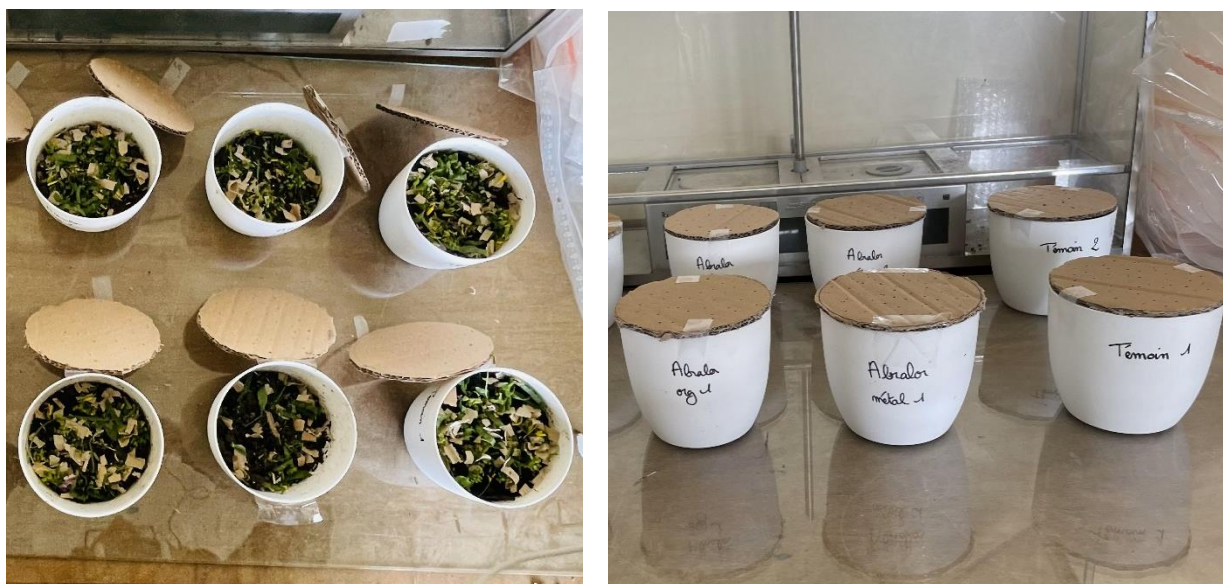
Figure 42 : Préparation et ajout de l'aliment (au jour 3 de l'acclimatation des vers de terre) recommandé par le fournisseur, et fermeture des pots pour démarrer l'essai
