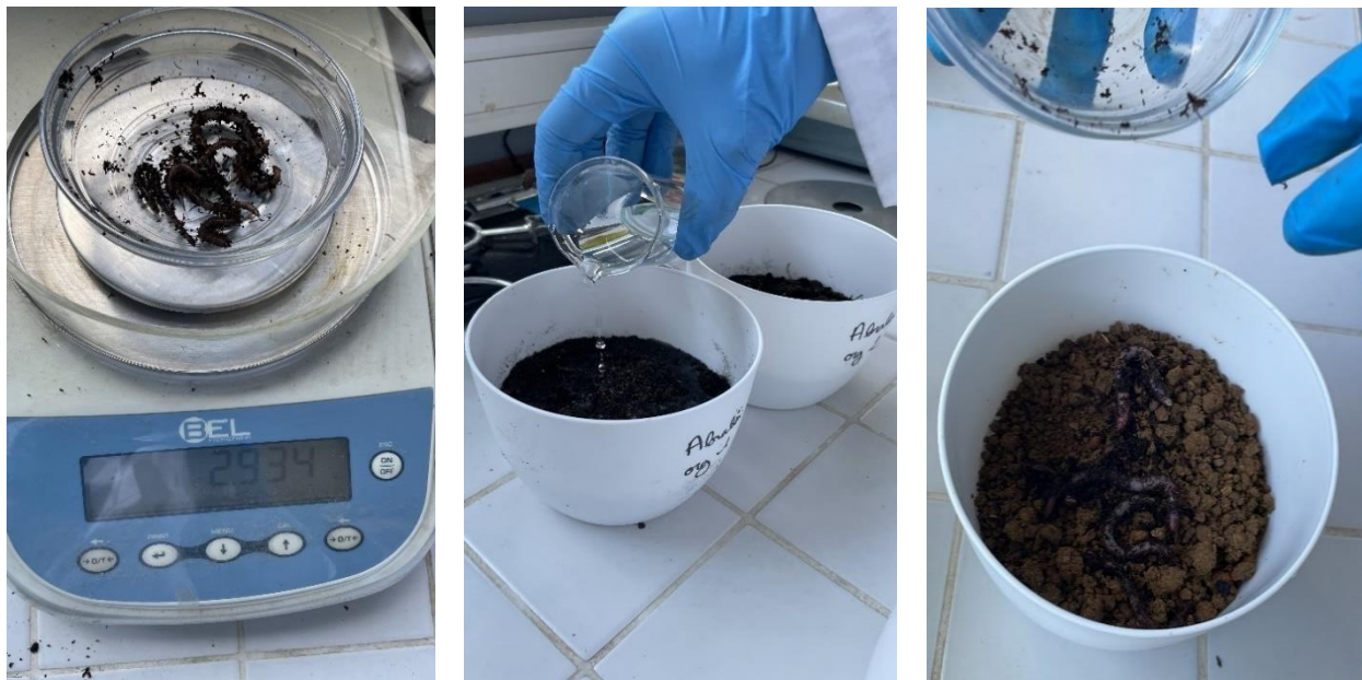
Figure 41 : Sélection, pesée, insertion et conditionnement des vers de terre dans les différents sols à évaluer
