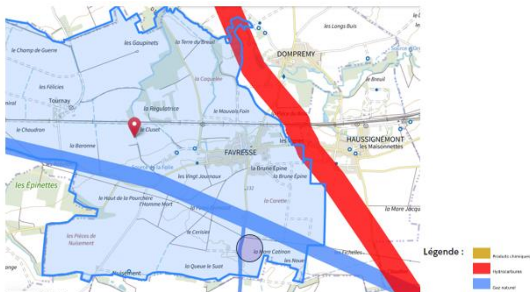
Figure 11 : réseaux de gaz et hydrocarbures
