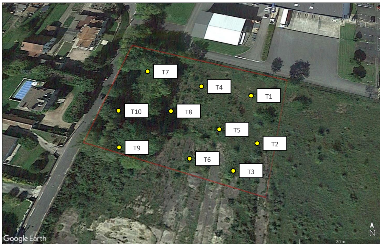
Figure 2 : Plan de localisation des sondages sur la base d'une vue aérienne
