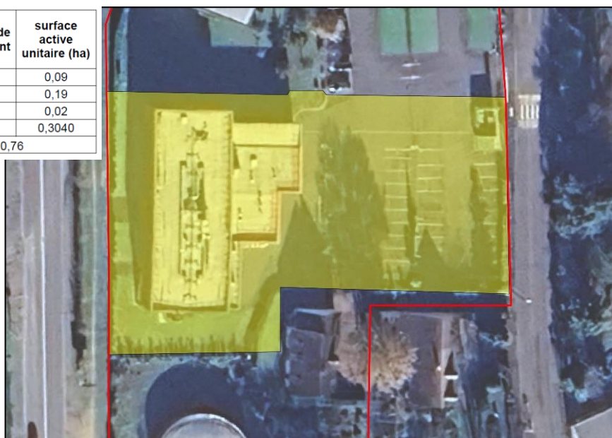
Figure 5 : Surfaces considérées dans la notice hydraulique de 2017
