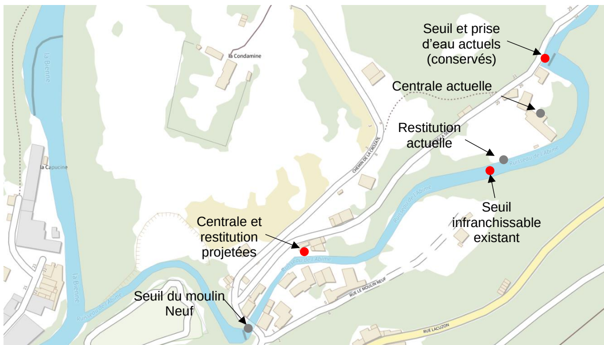
Figure 2 : Schéma de synthèse localisant les différents aménagements existants 8 et projetés (Source : Géoportail)
