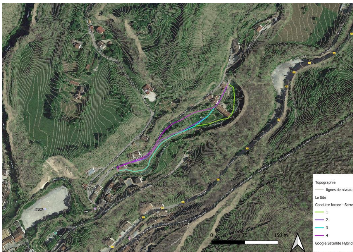
Figure 53 : Tracés étudiés pour le passage de la conduite forcée
