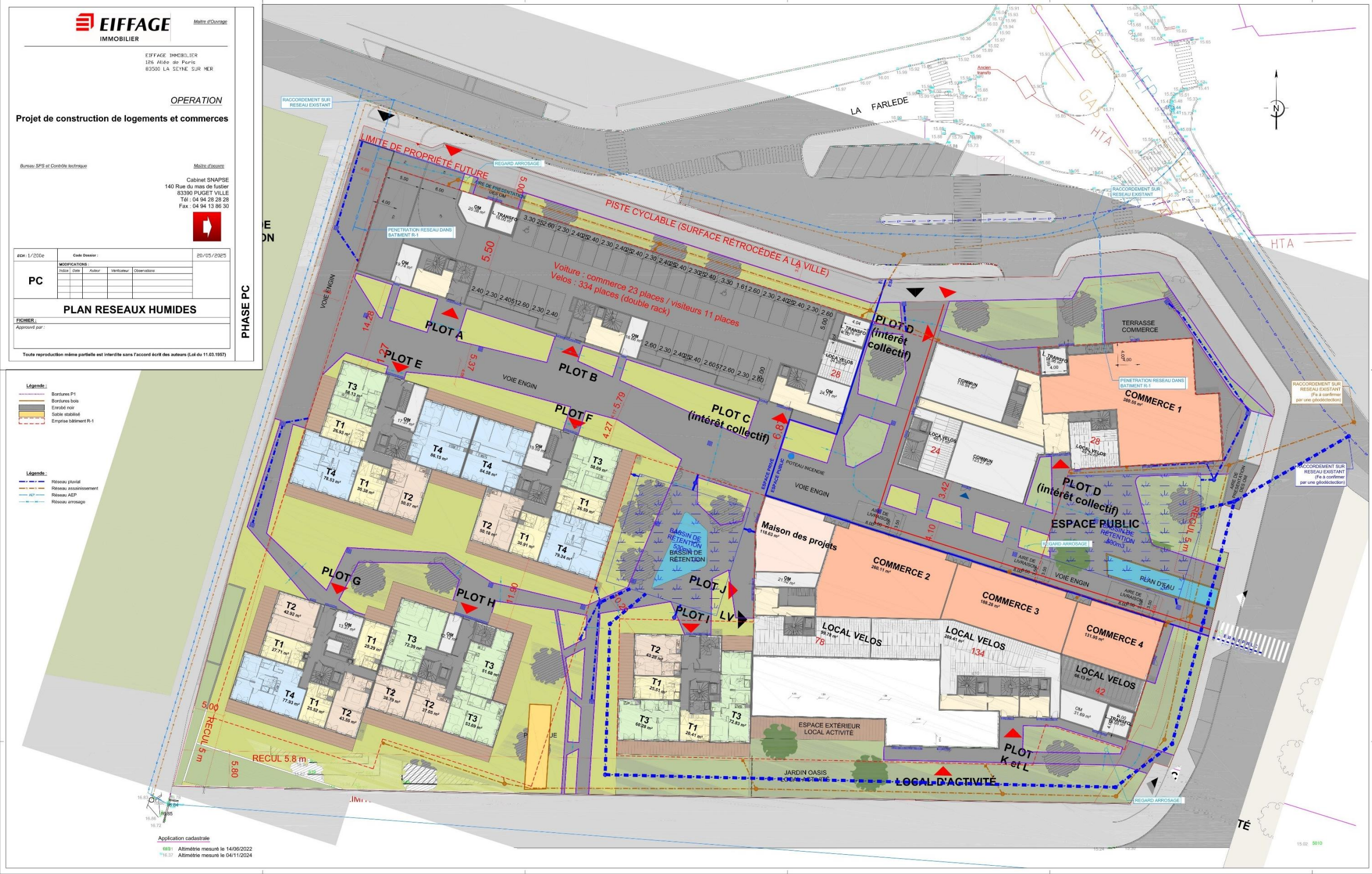
Figure 5 : Plan des réseaux humides projetés (source : EIFFAGE IMMOBILIER)
