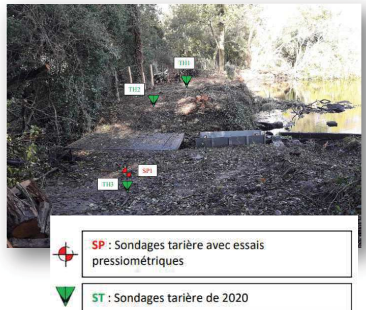
Figure 5 : Localisation des sondages et coupe géologique schématique (Source : GINGER CEBTP)
