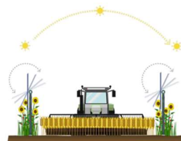
Visuel de l'inclinaison des trackers avec des tables 1 module. (Des tables 2 modules sont envisagés pour notre projet, espacées de 9m)
