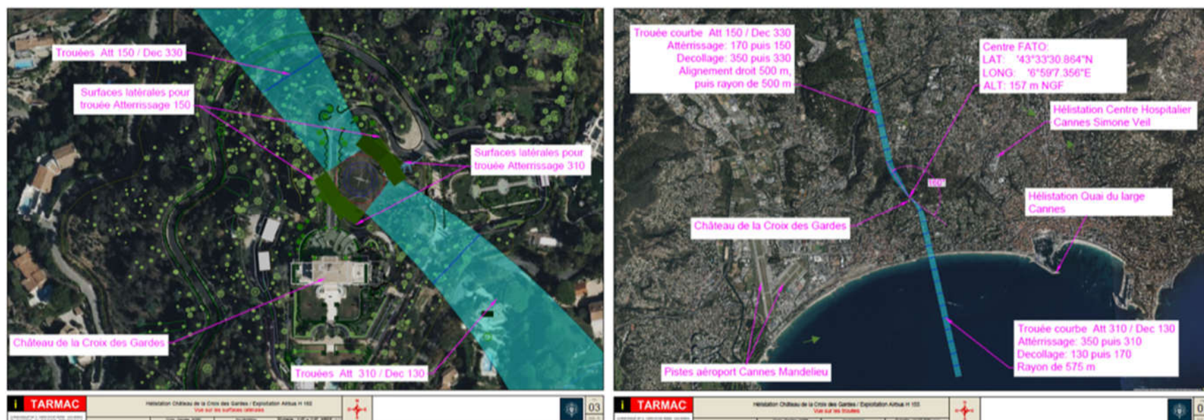
Représentation des surfaces de protections latérales et des trouées d'approche et de décollage de l'hélistation
