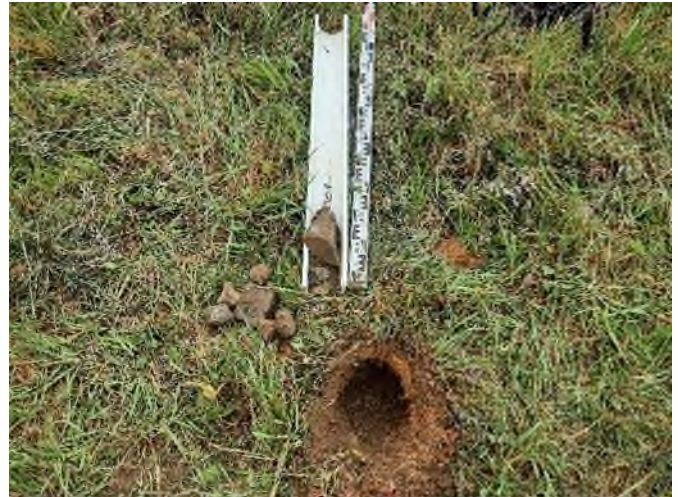
Illustration 8 : Sondage n°8 : refus à 20cm pour cause de présence de blocs
