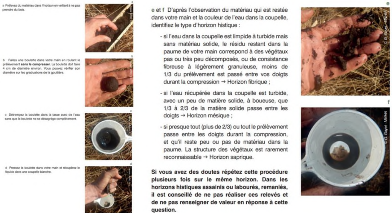
Illustration 5 : Test manuel pour déterminer le sous-type d'horizon histique (méthode nationale d'évaluation des fonctions des zones humides)
