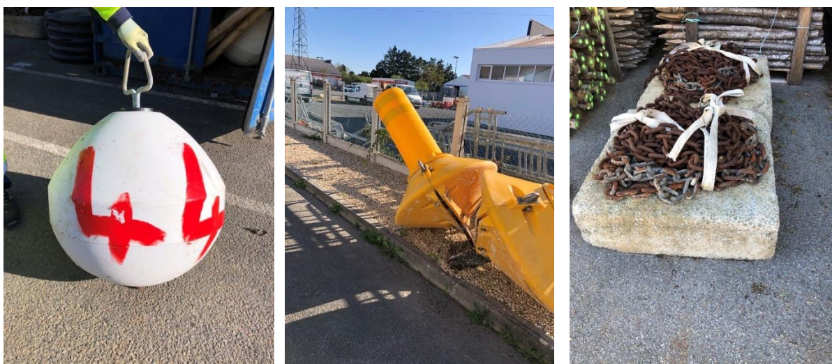
Photo 1 – Bouée de mouillage blanche, bouée de balisage jaune et bloc béton avec chaîne mère
