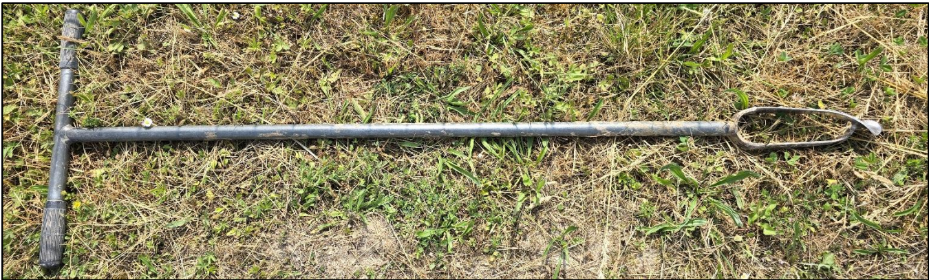
Photo 16 : Tarière Edelman ayant servie à réaliser les sondages pédologiques (Source : BEJC)
