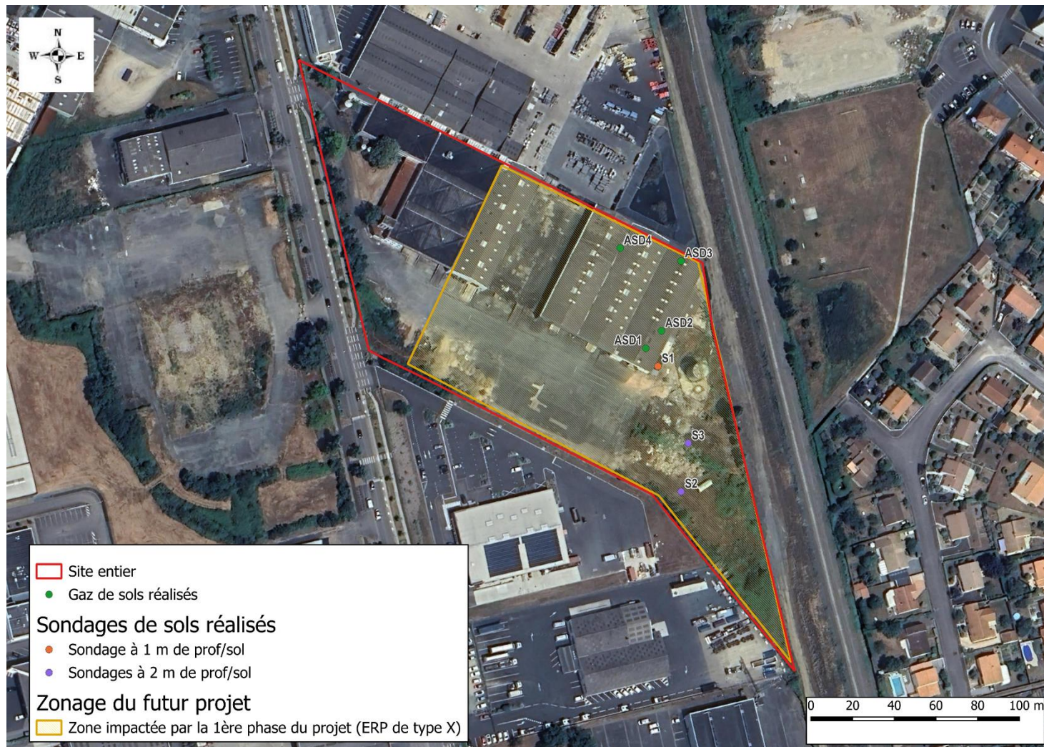
Figure 4 : Localisation des investigations réalisées sur site le 15/04/2025
