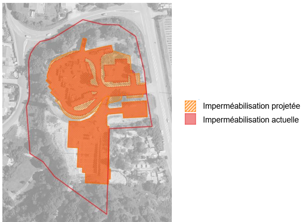
Illustration 9 : Spatialisation des surfaces imperméabilisées actuelles et projetées
