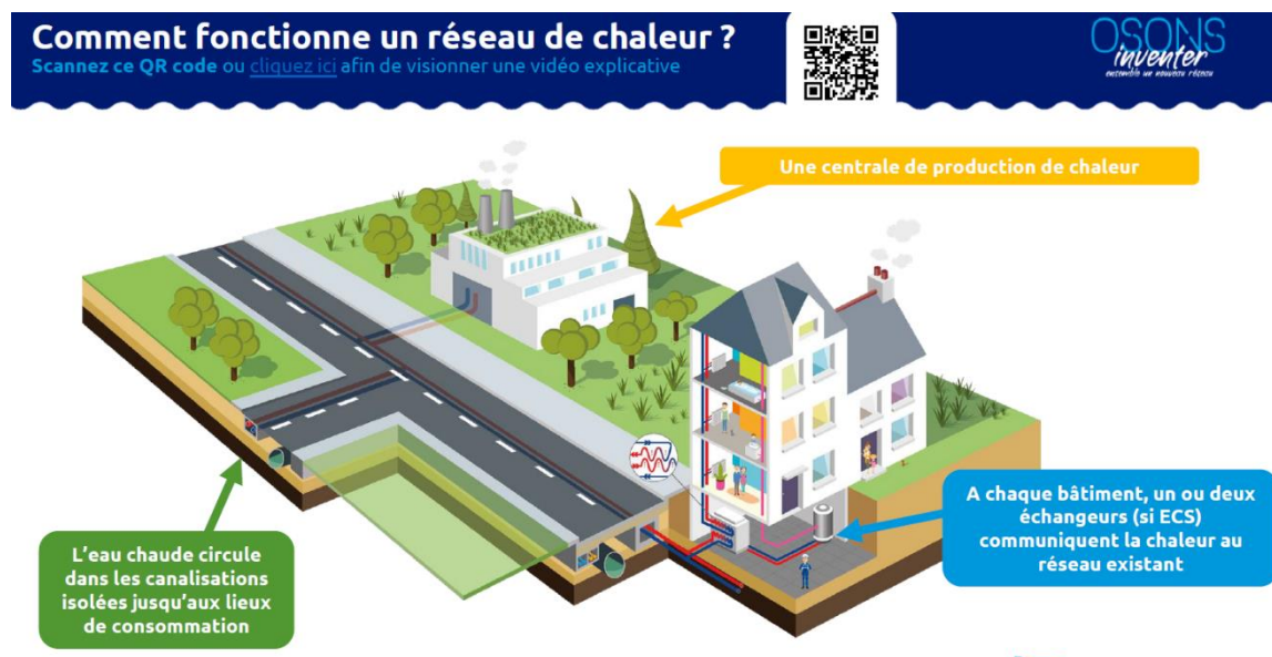
Figure 2 : fonctionnement d'un réseau de chaleur
