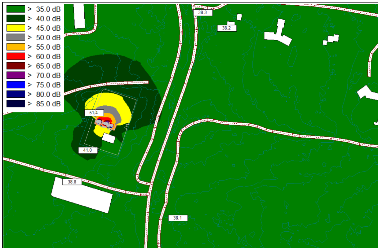
Illustration 20 : Résultats du modèle acoustique numérique du poste de Signes en situation de modélisation quatre
