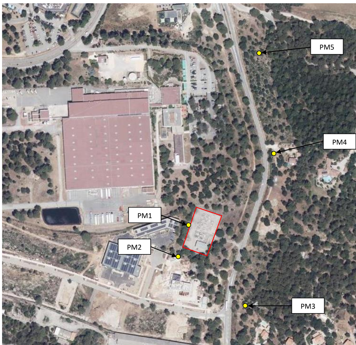
Illustration 10 : Localisation des points de mesures acoustiques
