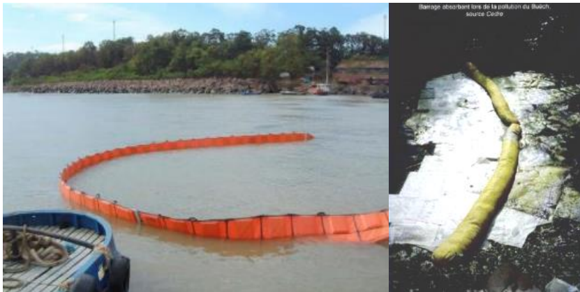
Figure 3 : Installation d'un barrage flottant ( http://www.flexitankchina.fr ) / Barrage absorbant (cedre.fr)
