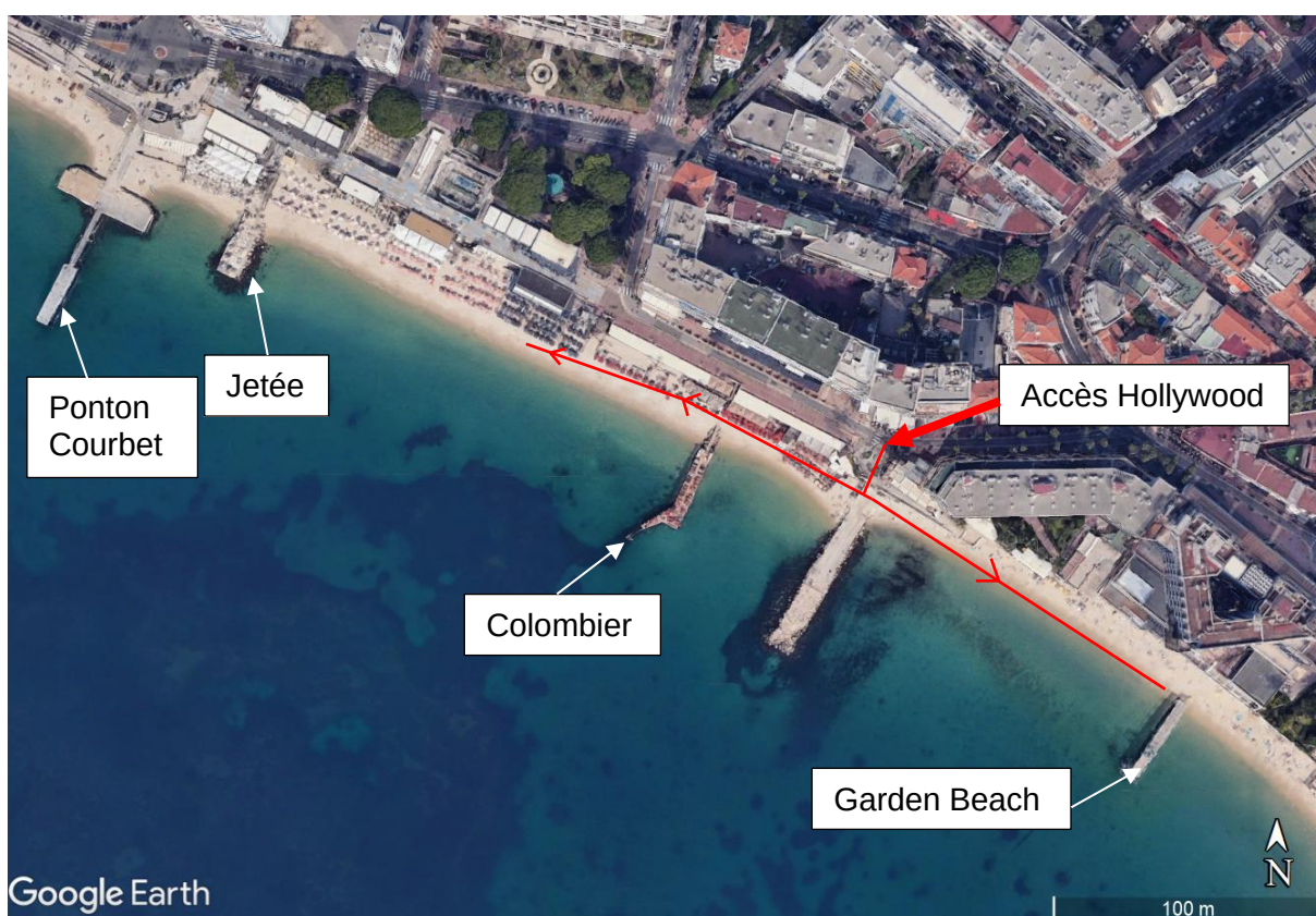
Figure 11 : Accès chantier jusqu'aux ouvrages à supprimer – Google Earth
