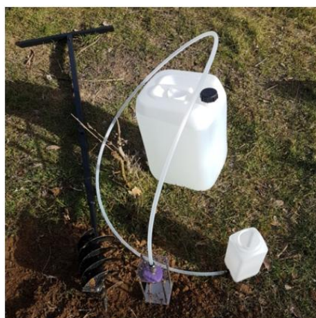
Mise en place du test de perméabilité par saturation du sol
