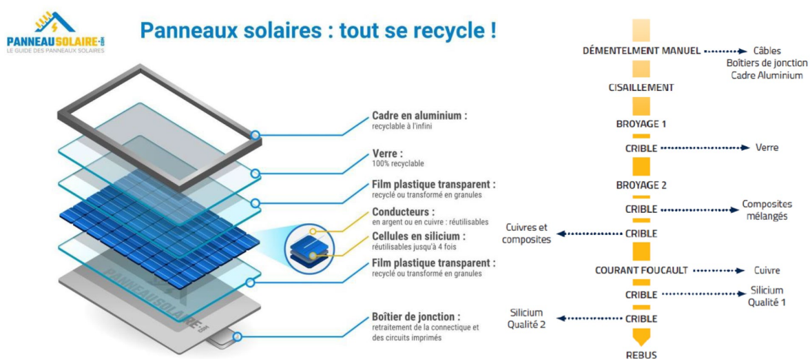
Figure 15 : Recyclage d'un panneau solaire (source : SOREN)
