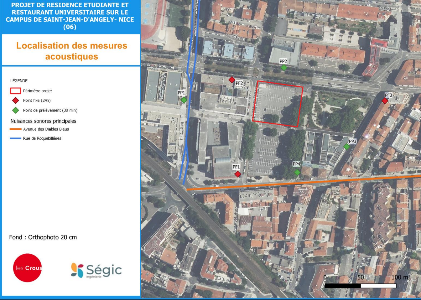
Figure 21 : Localisation des points de mesures acoustiques (Source : Ségic Ingénierie)
